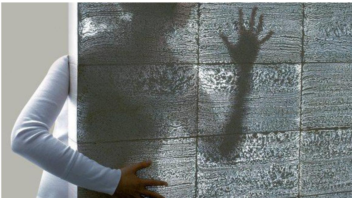
Изобрел и запатентовал технологию «Litracon» (light transmitting concrete) венгерский архитектор Арон Лосконши. Задумавшись над тем, как добавить в помещения из бетона солнечного света, при этом не нарушив прочности конструкции, он пришел к идее модификации внутреннего строения бетона. Добавив в состав раствора светопроводящее оптоволокно, Лосконши получил внешне привлекательные блоки, полностью соответствующие эксплуатационным характеристикам искусственного камня.
